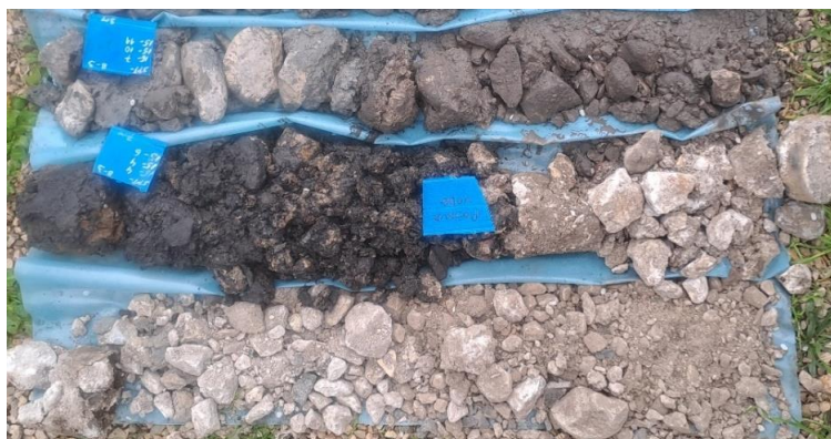
Slika 5: Nasip: zastupljen na površini terena, u debljini 2.0m (B-1) - a; i 1.3m (B-2) -b
