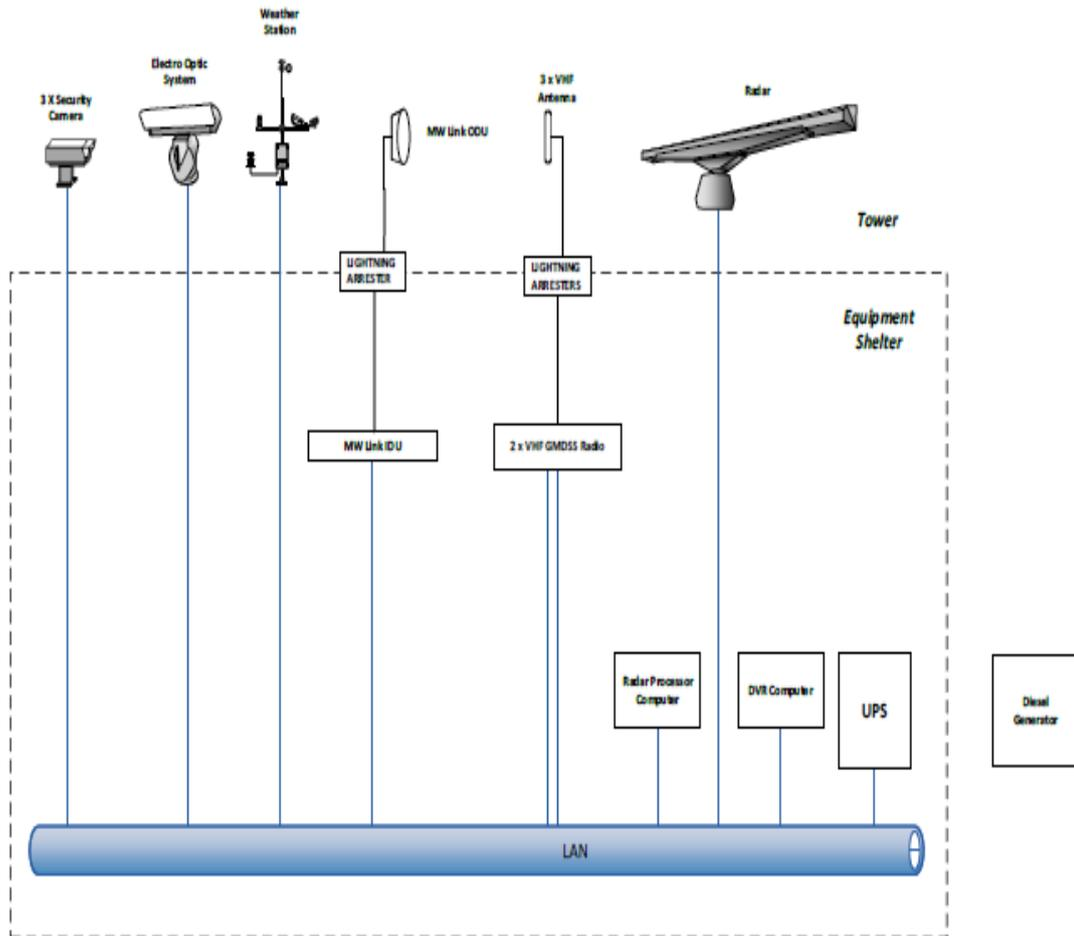
SI.3.4.2. Oprema koja se planira instalirati u Rtu Kobila
