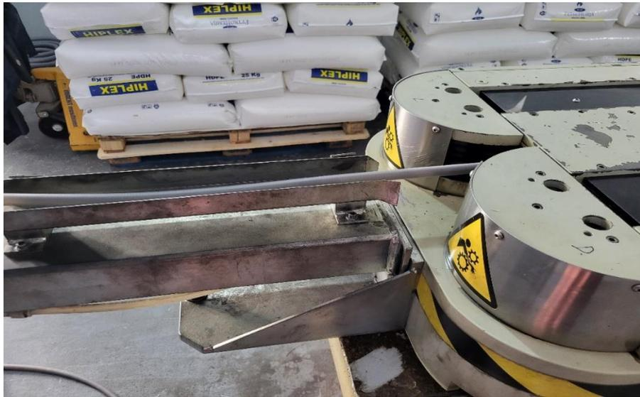
Slika 5.13. Zadnji dio ekstruder mašine, valci kroz koje izlaze gotova plastična crijeva
