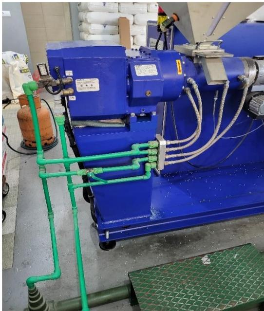
Slika 5.14. Vodovodne cijevi za hlađenje mašine.
