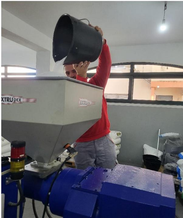
Slika 5.19. Sipanje sirovine u lijevak
