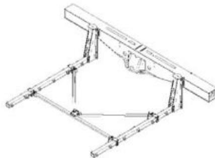
Šema nosača baterija sa ukrućenjem
