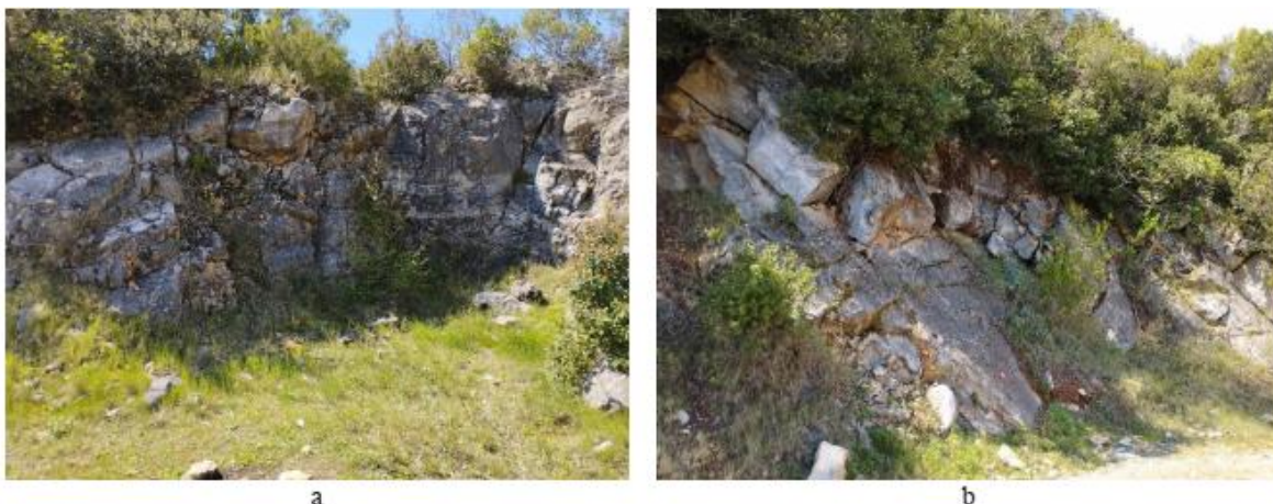
Slika 8: Bankoviti do masivni krečnjaci kredne starosti, uglavnom zastupljeni na površini terena, eventualno prekriveni crvenicom u manjoj debljini: zasek u neposrednoj blizini crkve na samom grebenu sa EPs 40/39 - a; zasek postojećeg puta ispod stuba 5 sa EPs 40/58 – b
