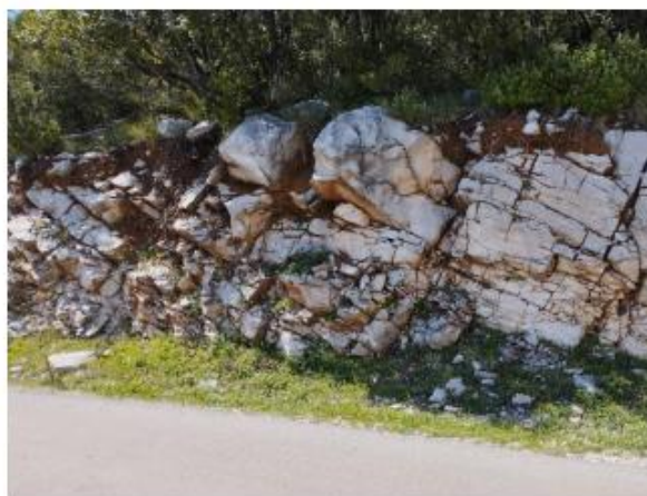
Slika 7: Slojeviti do bankoviti ispucali krečnjaci eocenske starosti, lokalno prekriveni tankim deluvijalno-eluvijalnim pokrivačem, u površinskoj zoni jače ispucali, vidljivi u zasecima uz postojeći put od Sutorinskog polja ka grebenu
