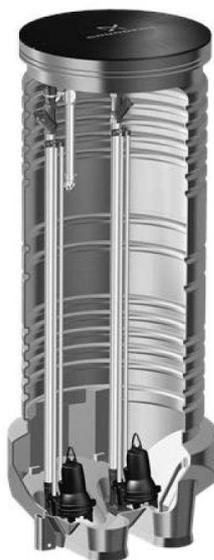
Odobrana je pumpna stanica tip PS.R.12.25. D.GC.304.65.A65.DP/SL firme Grundfos ili slična. Stanica je opremljena sa potrebnim cijevnim vezama, ventilima, nepovratnim ventilima, elektro opremom i upravljačkom jedinicom. Upravljačka jedinica u automatskom radu sama naizmjenično uključuje i isključuje pumpe tako da se sprječava blokada pumpe usled stajanja.
